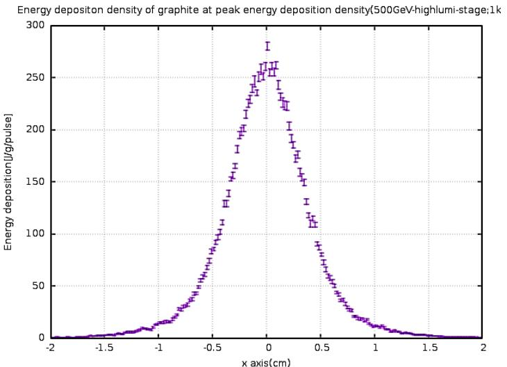
Mesh size : $(X-Y,Z)=(20\mu m,60\mu m)$ , Carbon density :  $1.82 g/cm^3$  24
