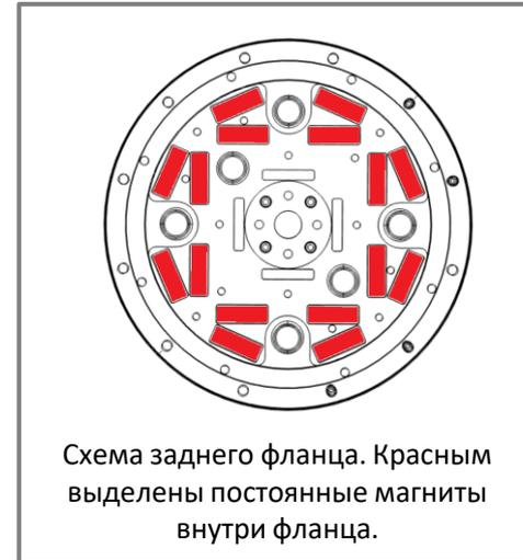
Схема заднего фланца. Красным выделены постоянные магниты внутри фланца.
