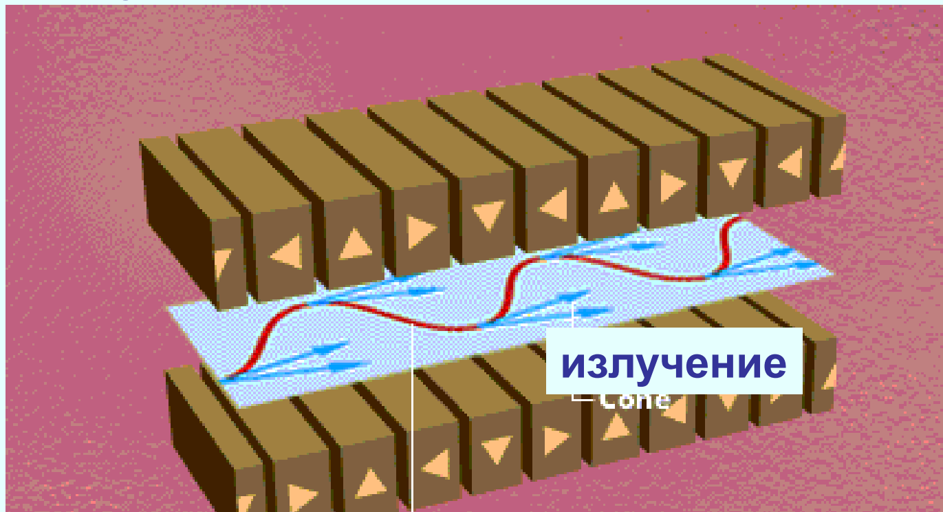
Траектория электрона в плоском ондуляторе.
