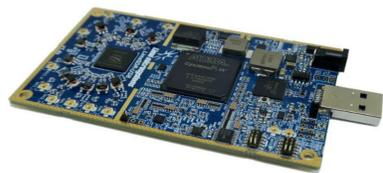
Рис.6 Модуль приём-передатчика LimeSDR
