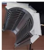
Рис.2 Сборка пикапа/кикера
