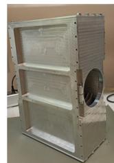
Рис.15 Изготовленный Шоттки-пикап в сборе
