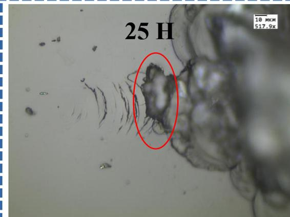
Оптическое изображение царапины на образце с а-C:H:SiO<sub>x</sub> покрытием.
