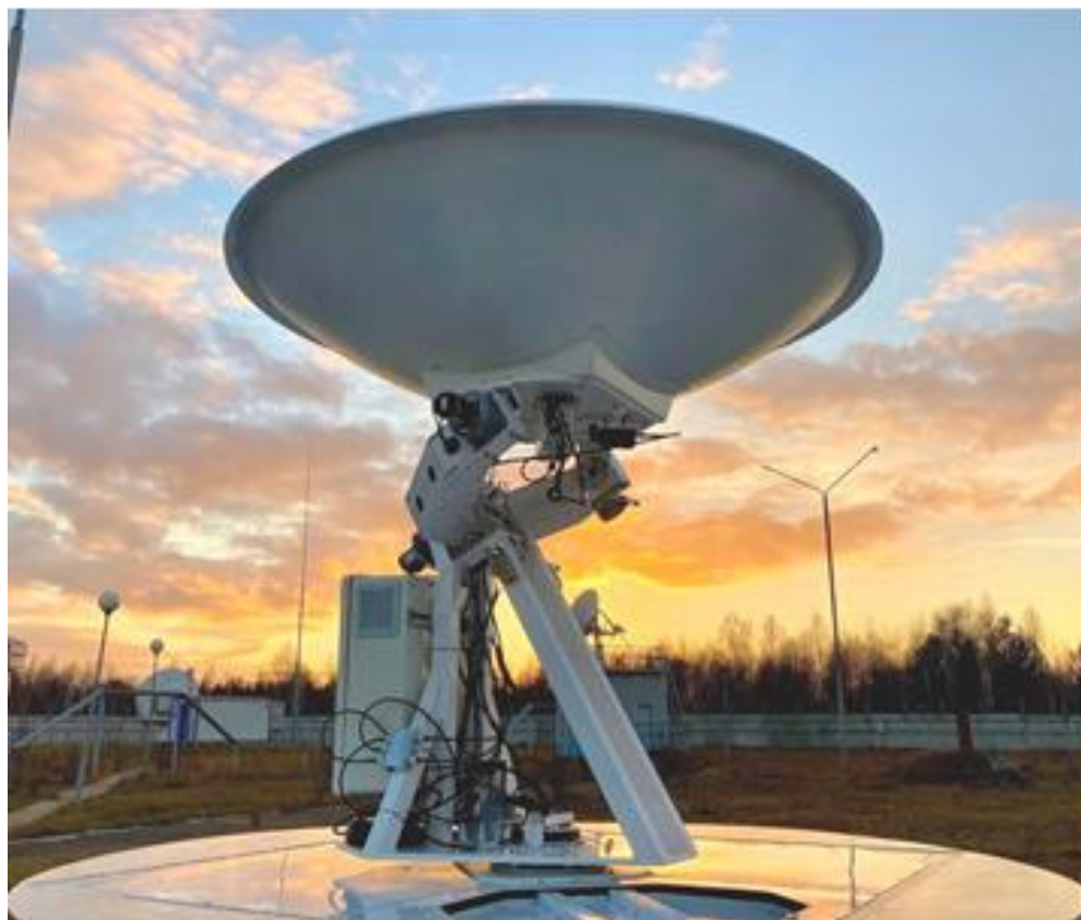
Фотографии зеркальной антенны наземной станции связи, установленной на опорно-поворотном устройстве для слежения за спутником «Скиф-Д»
