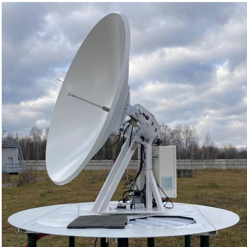
Фотографии зеркальной антенны наземной станции связи, установленной на опорно-поворотном устройстве для слежения за спутником «Скиф-Д»
