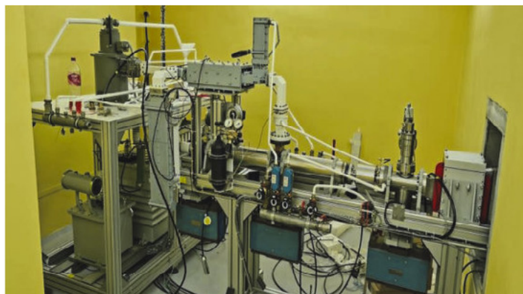
Рисунок 1 Излучатель ускорителя УЭЛР-10-10С-М
