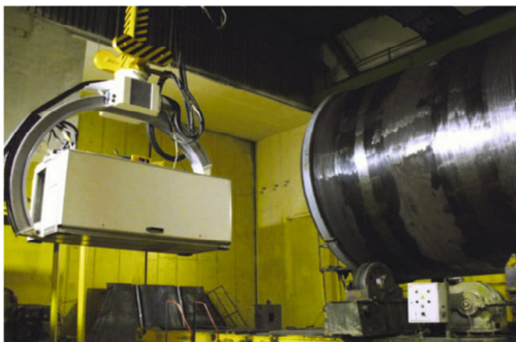
Рисунок 2 Ускоритель для неразрушающего контроля УЭЛ-10Д
