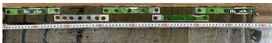
Рис. 1. Керна донных осадков оз.Чаша. Показан отбор образцов для сканирующего анализа.
