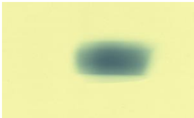
Поперечный «портрет» пучка на выходе из СМ-34, радиохромная пленка ЕВТ-3. Размер 30 x75 мм 2
