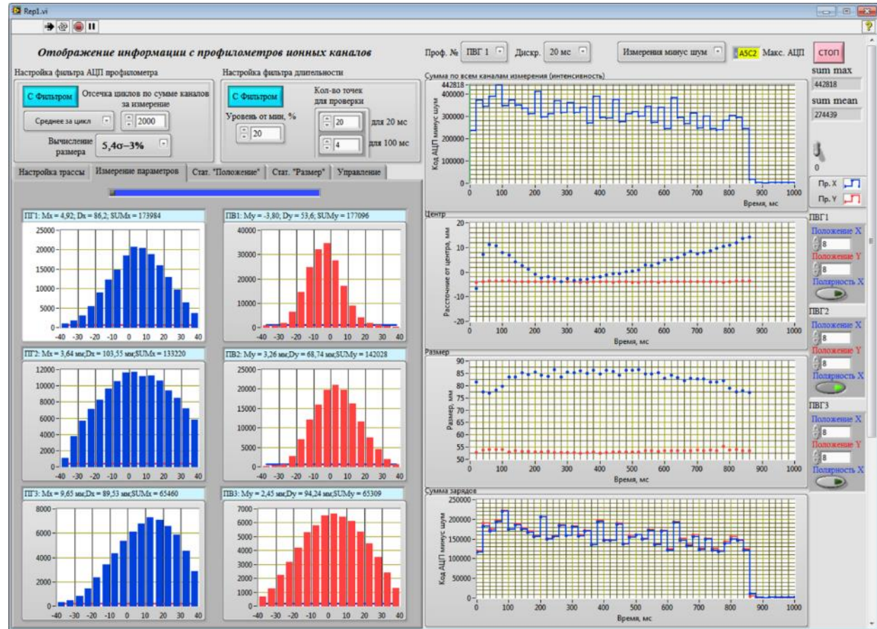
Профили пучка за один цикл вывода. Синий цвет – горизонталь, красный цвет – вертикаль. Сверху вниз профилометры по ходу пучка.
