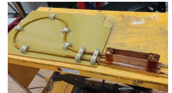
Обмотка квадруполя и петля из «гибкого» кабеля
