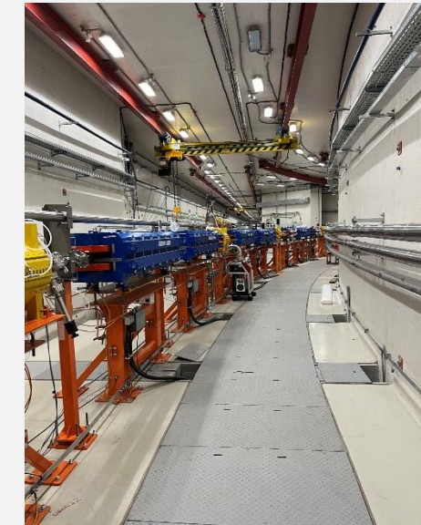
Монтаж каналов транспортировки Коллайдера (25 корректоров изготовлены в ИЯФ СО РАН)
