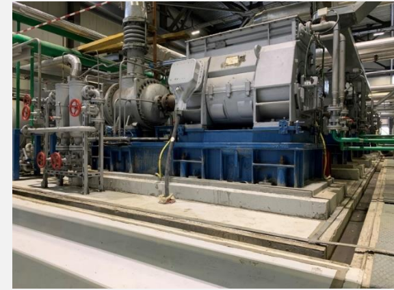
Два спиральных гелиевых компрессора «Каскад- 110/30»
