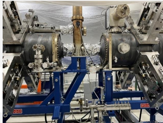
Две ВЧ1 и восемь ВЧ2 станций смонтированы в туннеле Коллайдера
