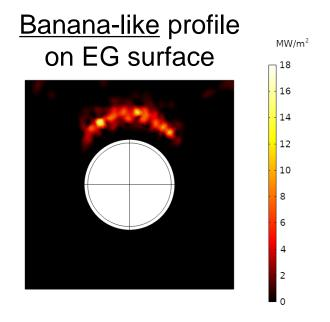
$B_r = 0.5T$ , max load: 18.2MW/m<sup>2</sup>
